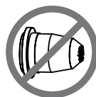
Rysunek 7.4 - Zużycie końcówki
