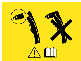
Afbeelding 5.17 - Foutscherm van de installatie van fakkel of verbruikartikelen
