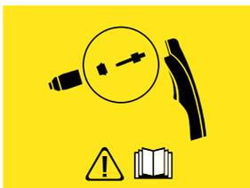
Illustration 5.18 - Écran d'erreur d'installation d'électrode ou de buse de coupe
