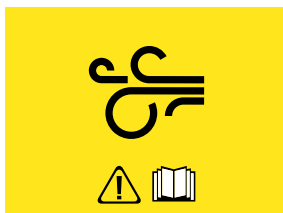
Figura 5.19 - Pantalla de Error de Presión de Aire
