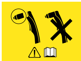
Figura 5.17 - Pantalla de error de instalación de la antorcha o de los consumibles
