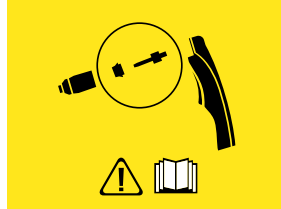
Abbildung 5.18 - Elektroden- oder Schneiddüsen-Installationsfehlerbildschirm
