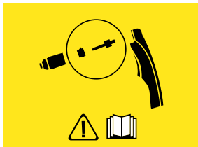
Figur 5.18 - Fejlskærm til installation af elektrode eller skæredyse
