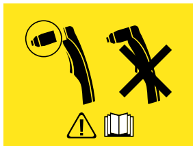
Figur 5.17 - Skærbillede af installationsfejl i brænder eller forbrugsstoffer
