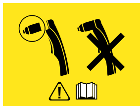
Фигура 5.17 - Екран с грешка при инсталиране на факел или консумативи
