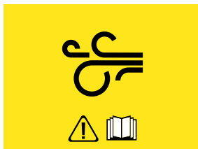
Фигура 5.19 - ЕКРАН ЗА ГРЕШКА ПРИ ВЪЗДУШНОТО НАЛЯГАНЕ
