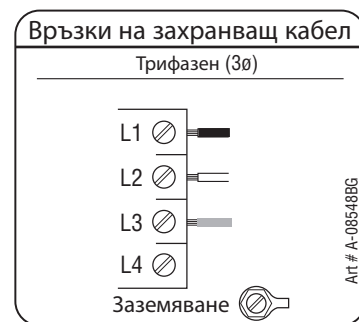
Окабеляване на трифазно захранване
