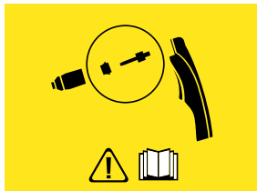
Joonis 5.18 - Elektroodi või löikamine otsik paigaldus viga ekraan
