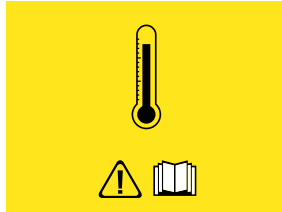
Joonis 5.21 - Ülekuumenemise Veaekraan
